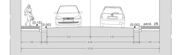
Sezione K-K Stato di progetto scala 1:50
