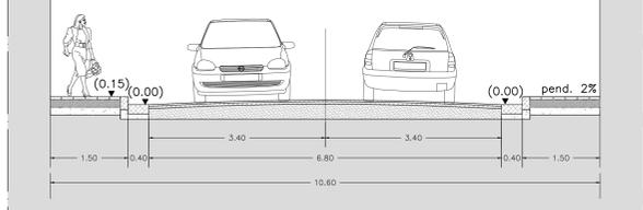
Sezione J-J Stato di progetto scala 1:50
